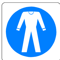
Nome: indumenti protettivi Posizione: All'ingresso del cantiere.
